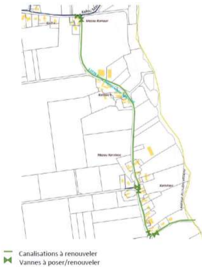
FIGURE 5 : PRESENTATION DU PROJET DE RENOUVELLEMENT – CARPONT 2
